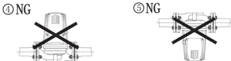
Рис. 3 Недопустимое расположение вала насоса
