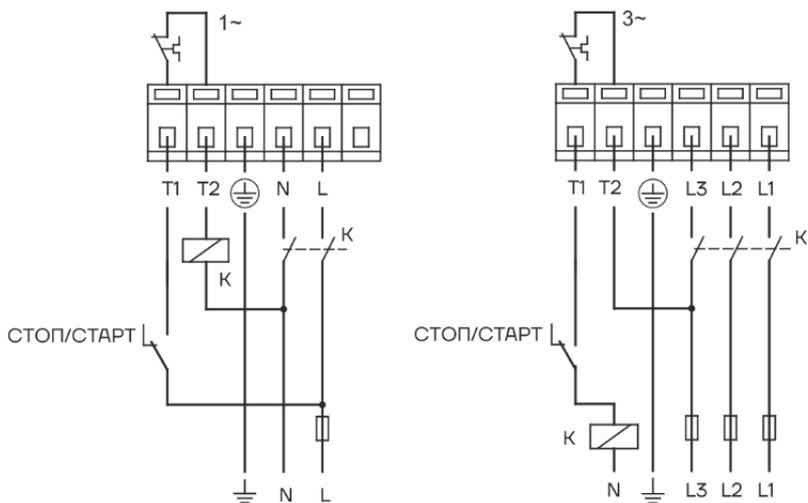
Рис. 13 Схема подключения при использовании внешнего механического пускателя
