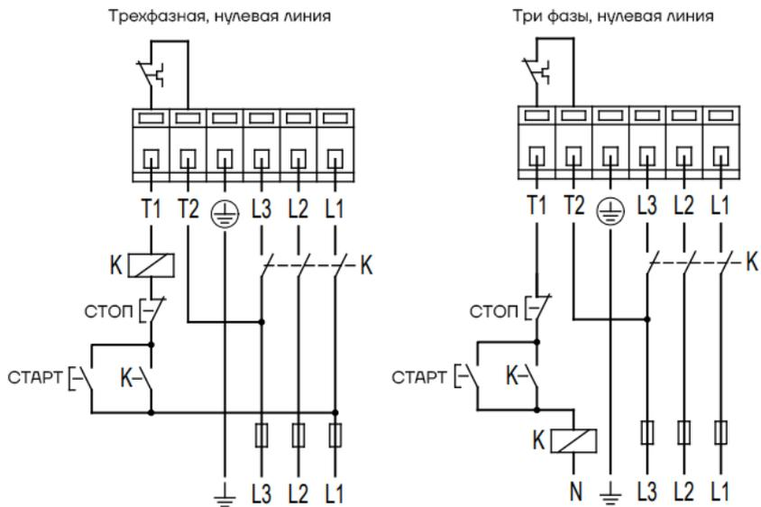
Рис. 12 Схема подключения при использовании внешнего электромагнитного пускателя
