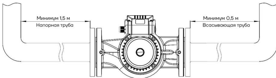
Рис. 3 Установка насоса
