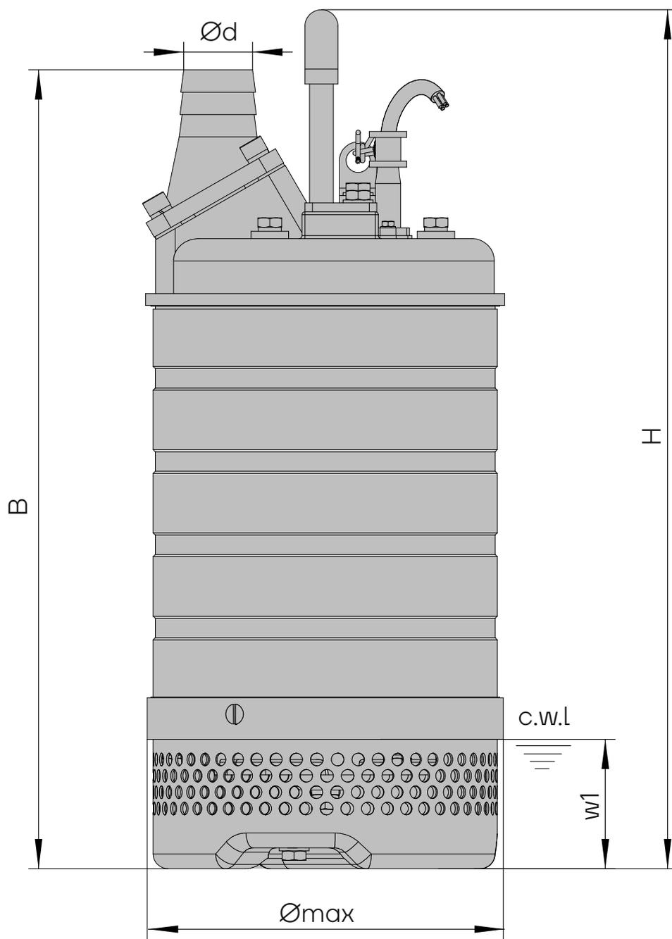
$B$  – расстояние от фильтра до напорного патрубка;
